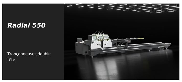
Tronçonneuse double tête électronique avec mouvement radial des lames, déplacement automatique de la tête mobile sur patins à recirculation de billes au moyen d'un système à pignon et crémaillère ; pivotement intérieur jusqu'à 30°, conçue pour la coupe de profils de grandes dimensions. L´avance de la lame est actionnée par deux cylindres oléopneumatiques.
