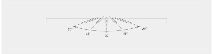
Réglage mécanique des angles intermédiaires
