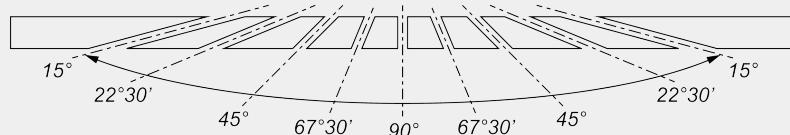
Réglage mécanique des angles intermédiaires
