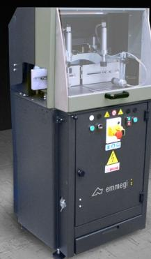
Tronçonneuse simple tête à lame ascendante, avec côté de chargement sur la gauche pour les angles de coupe de 15° gauche à 15° droite et pour les angles intermédiaires.
