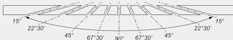
Réglage mécanique des angles intermédiaires
