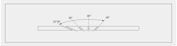
Réglage mécanique des angles intermédiaires
