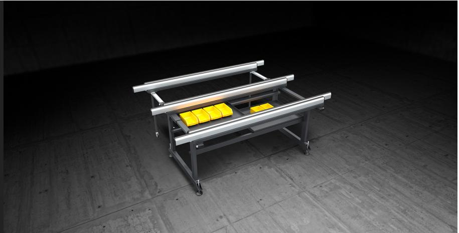
Montagetisch für alle Montagearbeiten an Fenstern und Türen. Die verschiebbaren und ausziehbaren Arbeitsflächen erlauben das absolut sichere Arbeiten an Rahmen in allen Größen und an sehr großen Strukturen.
