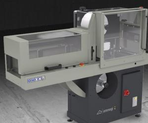
Maschine zum Anbringen einer Schutzfolie an Aluminiumprofilen. Der Profilvorschub erfolgt automatisch über motorisch angetriebene Walzen, und die perfekte Haftung der Folie am Profil wird durch Andruckrollen gewährleistet. Mit einem optionalen Bausatz besteht außerdem die Möglichkeit, eine dritte Profilseite gleichzeitig mit der Folie zu beschichten.
