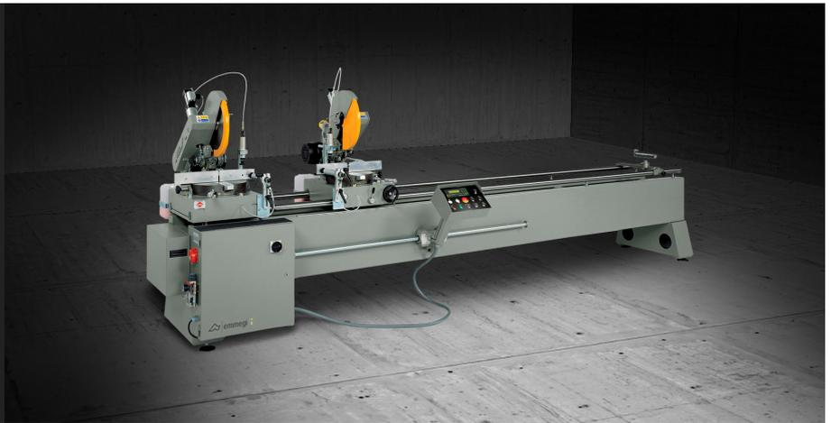
Elektronische Doppelgehrungssäge mit manuell verfahrbarem rechtem Sägeaggregat. Manuelles Gehrungsschwenken links und rechts 45°. Manuelles Schwenken der Schifterschnitteinrichtung 90° - 45° einseitig. Erhältlich mit einer Nutzschnittlänge von 4 oder 5 m.
