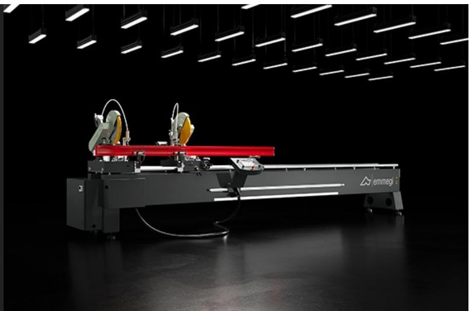
Doppelgehrungssäge mit manuell verfahrbarem Sägeaggregat und Positionserfassung über absoluten Magnetstreifen. Die Drehung der Sägeaggregate um die vertikale Achse ( $45^\circ$  nach links und rechts) sowie die Neigung auf der horizontalen Achse ( $45^\circ$  nach innen), mit manueller Einstellung, ermöglichen auf Zwischengehrenungen.
