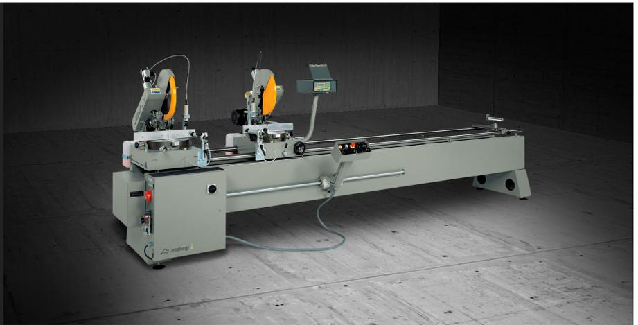
Elektronische Doppelgehrungssäge mit manuell verfahrbarem rechtem Sägeaggregat. Manuelles Gehrungsschwenken links und rechts 45°. Visualisierung des Längenmaßes mit digitaler Längenmaßanzeige. Manuelles Schwenken der Schifterschnitteinrichtung 90° - 45° einseitig. Erhältlich mit einer Nutzschnittlänge von 4 oder 5 m.
