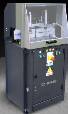
Einkopfsäge mit von unten kommendem, bewegtem Sägeblatt, Zufahrseite links für 15° Gehrungen links bis 15° Gehrungen rechts und Zwischengehrungen.
