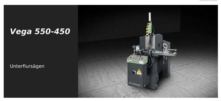
Gehrungssäge mit nach vorne ausfahrendem Sägeblatt, Zufuhrseite links; horizontales pneumatisches Schwenken auf feste Gehrungswinkel: links 45° und 90°, rechts 45° und 22°30′. Ein spezieller mechanischer Anschlag ermöglicht auch das Schneiden von Zwischengehrungen.
