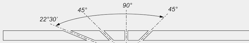
Mechanische Einstellung der Zwischenwinkel
