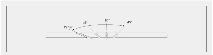
Mechanische Einstellung der Zwischenwinkel
