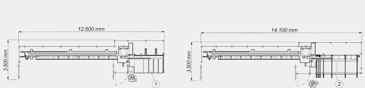
1. Entlademagazin mit automatischer Entnahmeeinrichtung (Standard)
