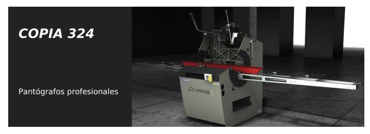
Pantógrafo monocabezal con descenso manual con bloqueo neumático y movimiento de traslación del cabezal mediante la palanca indirecta. Posibilidad de realizar trabajos pasantes en aluminio sin girar la pieza. Plano de trabajo antirayado. Palpador manual.
