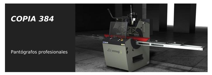
Pantógrafo monocabezal de mando manual con bloqueo neumático y movimiento de traslación del cabezal mediante la palanca indirecta. Velocidad de rotación herramienta que se puede cambiar con variador electrónico para permitir las mecanizaciones en acero hasta 2 mm, y para mejorar la calidad de los fresados y la duración de la herramienta. Posibilidad de realizar trabajos pasantes en aluminio sin girar la pieza. Plano de trabajo antirayado. Palpador manual.
