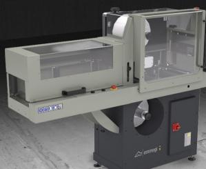
Máquina para la aplicación de una película de protección en los perfiles de aluminio. El perfil avanza automáticamente por medio de rodillos motorizados. Unos rodillos prensores hacen que se adhiera perfectamente la película al perfil. Un juego opcional adicional permite aplicar la película simultáneamente también a una tercera superficie.
