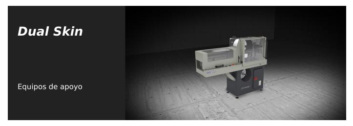
Máquina para la aplicación de una película de protección en los perfiles de aluminio. El perfil avanza automáticamente por medio de rodillos motorizados. Unos rodillos prensores hacen que se adhiera perfectamente la película al perfil. Un juego opcional adicional permite aplicar la película simultáneamente también a una tercera superficie.
