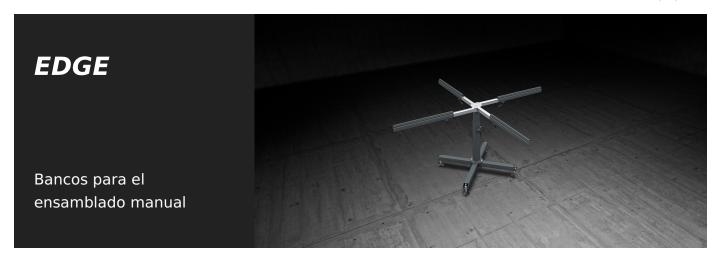
Banco de montaje de accesorios y juntas de goma. Gira sobre un eje central y puede alargarse. Permite girar el marco.
