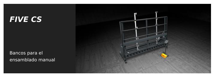
Banco de ensamblaje, acristalado y verificación para carpinterías de aluminio y PVC. En él se pueden simular las condiciones de empleo de la carpintería: un sistema de mordazas, regulables en toda la altura del cerramiento, bloquea el marco; las hojas se montan en el interior del marco; se instala el vidrio y se efectúa la prueba final. El usuario puede cargar y descargar las carpinterías pesadas gracias a la presencia de la base de rodillos.
