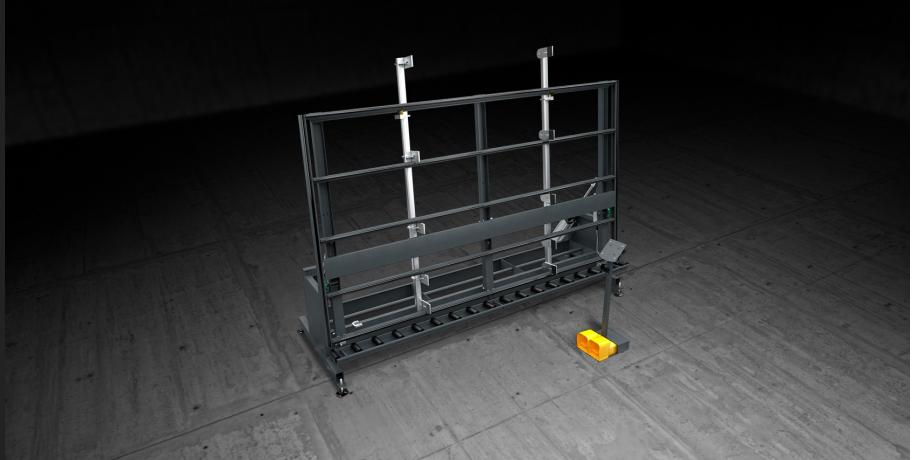
Banco de ensamblaje, acristalado y verificación para carpinterías de aluminio y PVC. En él se pueden simular las condiciones de empleo de la carpintería: un sistema de mordazas, regulables en toda la altura del cerramiento, bloquea el marco; las hojas se montan en el interior del marco; se instala el vidrio y se efectúa la prueba final. El usuario puede cargar y descargar las carpinterías pesadas gracias a la presencia de la base de rodillos.
