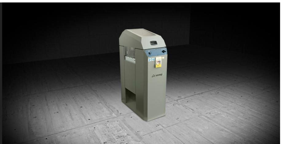
Fresadora retestadora horizontal con avance manual. Fresado en escuadra a 90°. Cambio rápido del grupo de fresado con mando de palanca. Plano de apoyo perfil antirrayas. Zona de mecanizado protegida integralmente.
