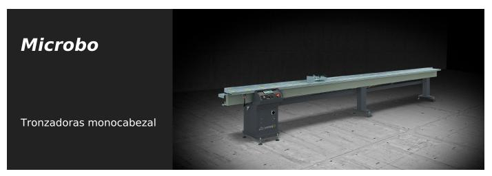
Dispositivo compuesto por tope de medida y soporte del perfil con posicionamiento del mismo tope mediante un motor en C.C. y lectura electrónica mediante encoder.
