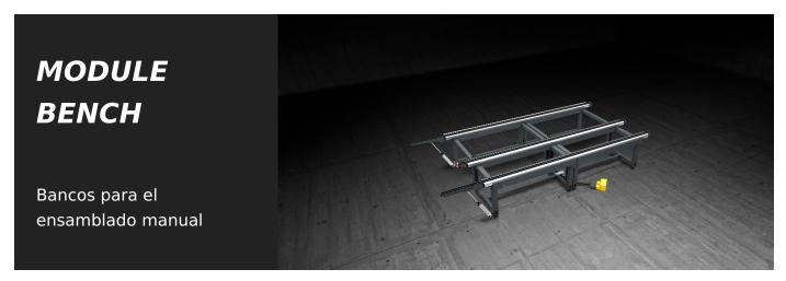
Banco modular de gran tamaño, extensible, para el ensamblaje de carpinterías y modulos de fachadas. Posee 3 planos de apoyo diferentes: uno de PVC blando para el ensamblaje, uno de PVC rígido antifricción para la rotación y una base de rodillos para el desplazamiento en línea.
