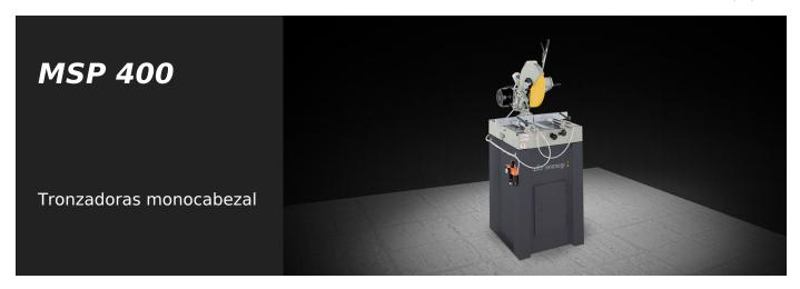
Tronzadora con una unidad de corte descendente, lado izquierdo de carga, rotación de la unidad de corte a 45° (a la derecha y a la izquierda) e inversión manual a 45° respecto al eje horizontal.
