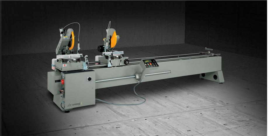
Tronzadora de doble cabezal electrónica con movimiento automático del cabezal móvil . Rotación (45° izquierda y derecha) y vuelco manual (45° en relación con el eje horizontal) de las unidades de corte. Disco de 400 mm. Disponible con corte útil de 4 m o 5 m de longitud.
