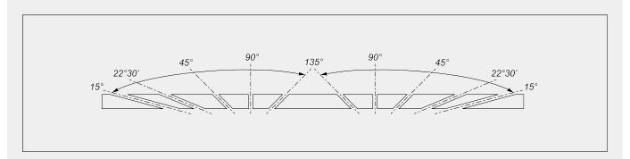
Regulación electrónica de los ángulos intermedios
