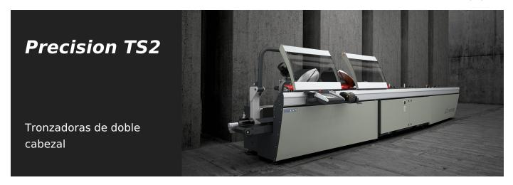
Tronzadora de doble cabezal de 3 ejes controlados con movimiento automático del cabezal móvil y gestión electrónica de todas las angulaciones de 45° (internos) a 15° (externos) con una precisión, en el ámbito de cada grado, de 280 posiciones. El avance del disco es accionado por dos cilindros oleoneumáticos.
