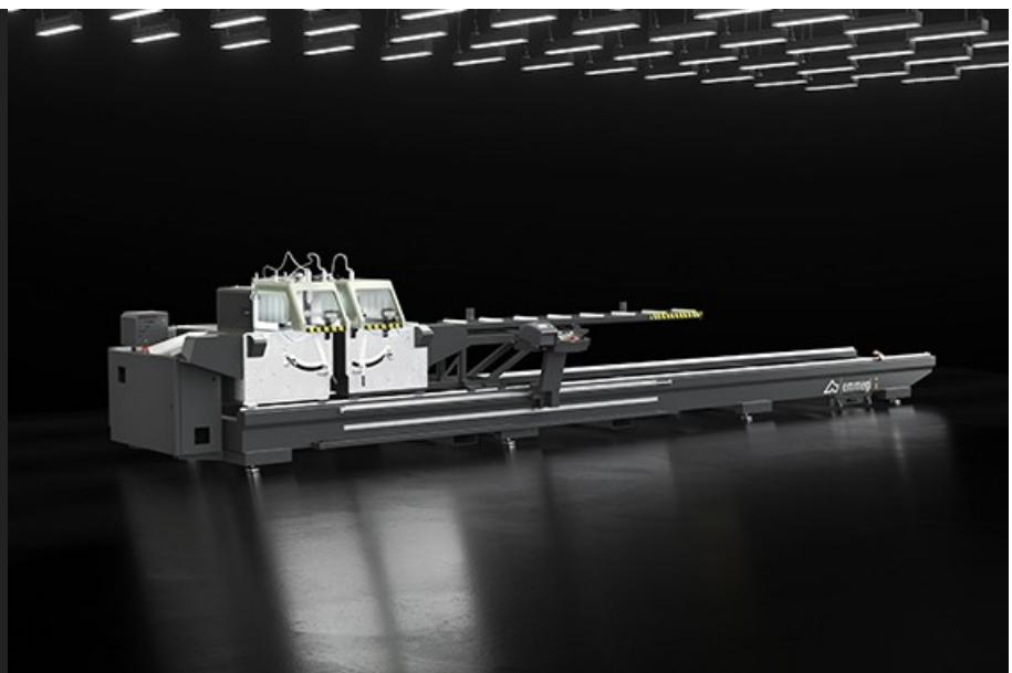
Tronzadora electrónica de doble cabezal con movimiento radial de los discos, desplazamiento automático del cabezal móvil en patines con recirculación de bolas mediante sistema de piñón y cremallera; giro interno de hasta 30°. Sirve para cortar perfiles de grandes dimensiones. El avance del disco es accionado por dos cilindros oleoneumáticos.
