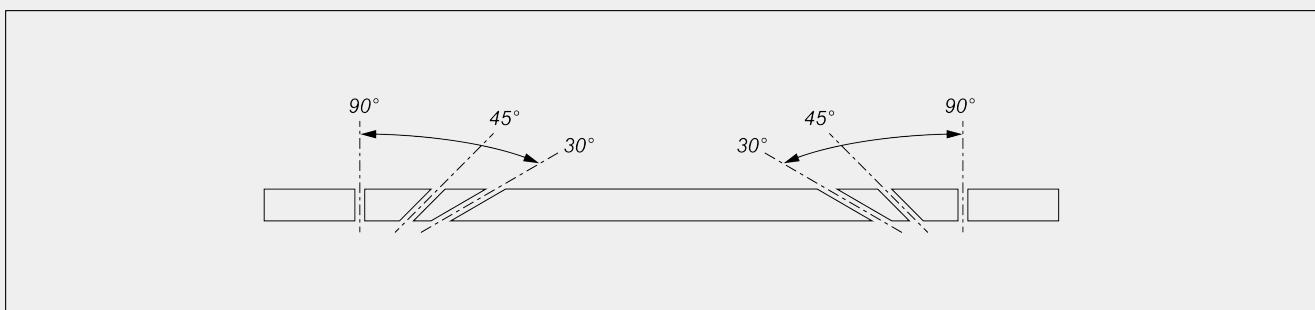
Regulación electrónica de los ángulos intermedios
