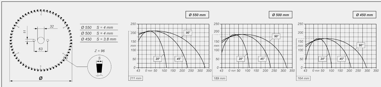
**INCLINACIÓN CABEZAL DE CORTE**
