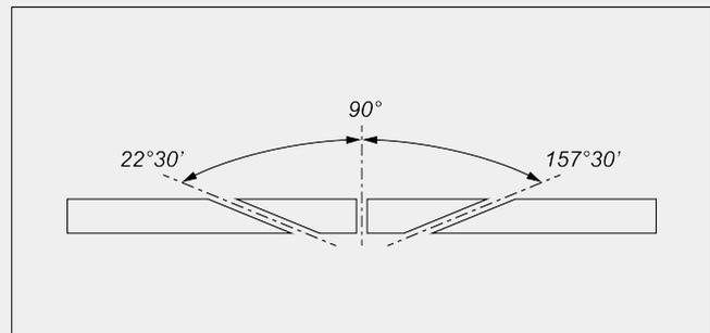
Regulación electrónica de los ángulos intermedios
