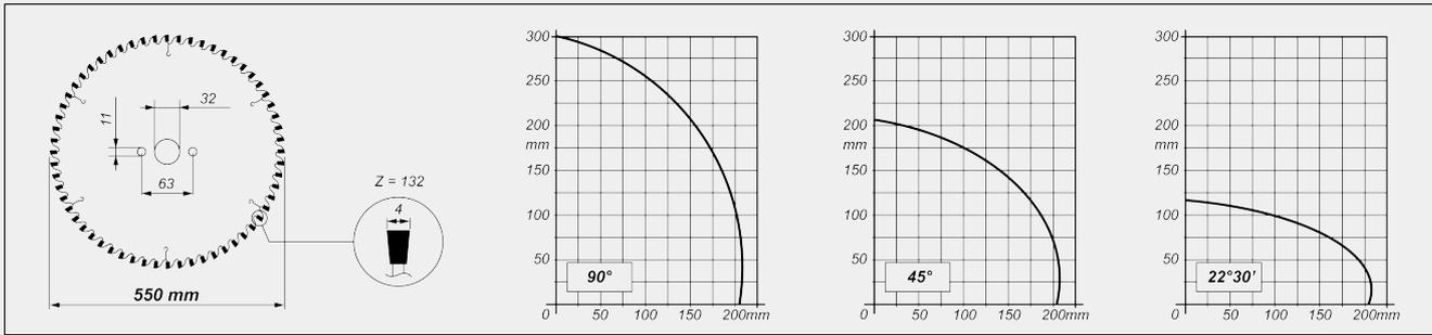
**INCLINACIÓN CABEZAL DE CORTE**
