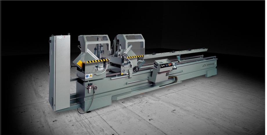
Coupeuse à double tête électronique avec un mouvement automatique de la tête mobile grâce à un moteur à courant continu (C.C.) commandé par un contrôle numérique. Gestion pneumatique de tous les angles jusqu'à 22°30' (externes).
