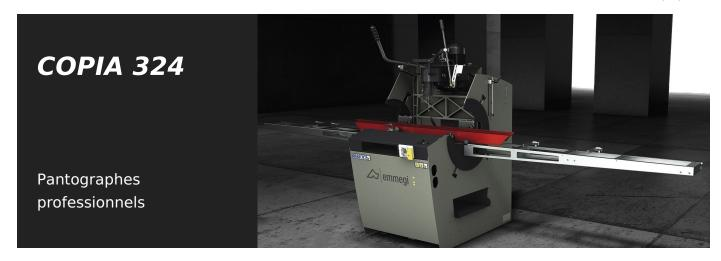
Pantographe à tête simple à commande manuelle avec blocage pneumatique et mouvement de translation de la tête à travers un levier indirect. Possibilité d'effectuer des usinages passants sur aluminium sans tourner la pièce. Plan de travail anti-rayure. Palpeur à commande manuelle.
