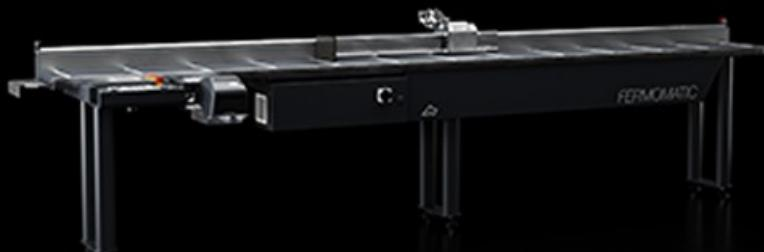
Système de référence mesure et support profil avec mouvement de la butée par moteur sans balais et lecture électronique par bande magnétique absolue. Disponible en trois longueurs avec une grande précision et répétabilité de positionnement.
