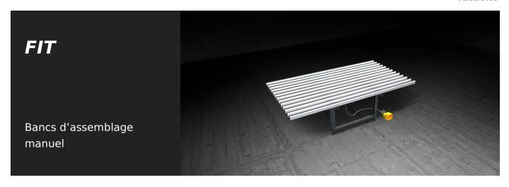
Table pour l'assemblage d'ouvrants et de châssis. Table horizontale avec levage pneumatique entre la surface d'appui en PVC souple (pour la phase d'assemblage) et la surface d'appui en PVC dur antifriction (pour la phase de déplacement).
