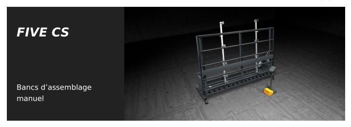
Table pour les essais de fonctionnement sur les menuiseries en aluminium et PVC qui permet de recréer les conditions d'utilisation des menuiseries: le châssis est bloqué par un système d'étaux réglables sur toute sa hauteur, les ouvrants et les vitrages sont introduits à l'intérieur du châssis et les derniers essais ont lieu. L'amenage permet à l'opérateur de charger et de décharger des châssis encombrants de façon parfaitement autonome.
