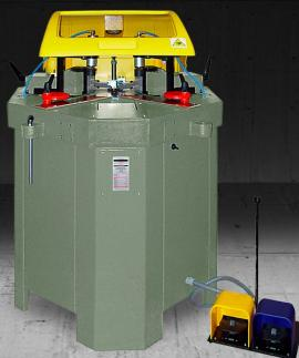
Sertisseuse pour fermer les angles de profilés en aluminium de toutes les typologies. Facile à régler grâce à la translation des unités de poinçonnage. Les blocs de couteaux sont équipés de déclenchement rapide et d'aimant pour éviter leur chute. Facile à utiliser et polyvalent.
