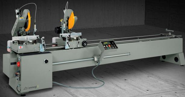
Coupeuse à double tête électronique avec un mouvement automatique de la tête mobile. Rotation (45° gauche et droite) et basculement manuel (45° en fonction de l'axe horizontal) des unités de coupe. Lame de 400 mm Disponible avec une coupe utile de 4 m ou 5 m de long.
