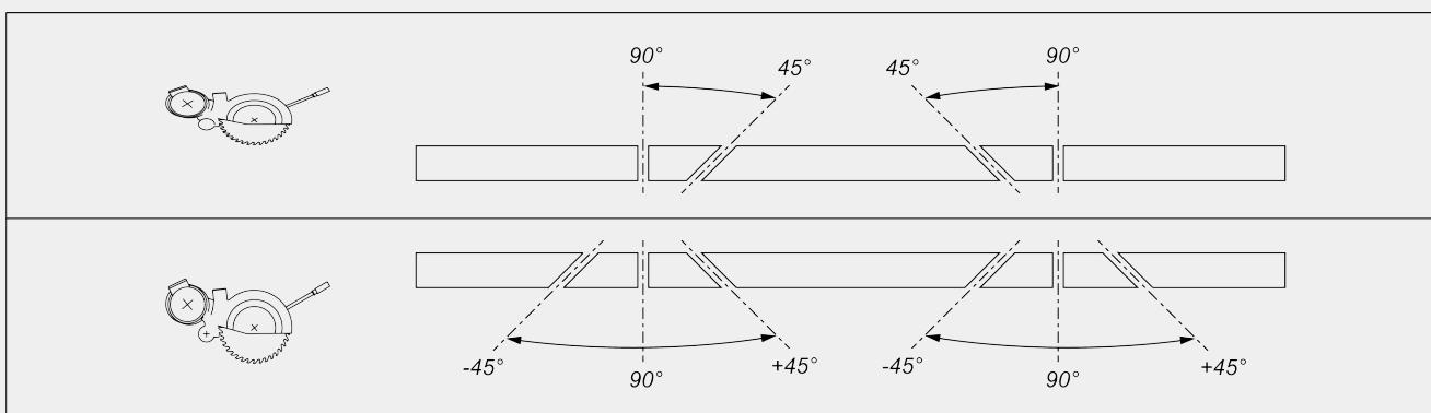
Réglage mécanique des angles intermédiaires
