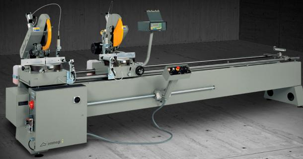
Coupeuse à double tête avec un mouvement manuel de la tête mobile et un afficheur numérique de cote (Norma Vis). Rotation (45° gauche et droite) et basculement manuel (45° en fonction de l'axe horizontal) des unités de coupe. Lame de 400 mm Disponible avec une coupe utile de 4 m ou 5 m de long.
