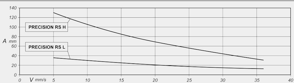
A = arc de contact (mm) V = vitesse d'avance de la lame (mm/s)
