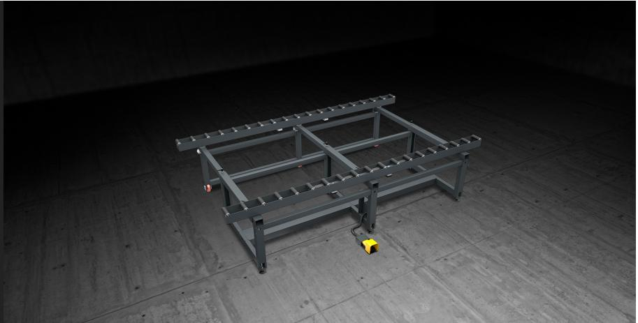
Table modulaire de grandes dimensions conçue pour le montage et la manutention en ligne de cadres de murs-rideaux. Equipée de deux chemins d'aménagement recouverts d'une gaine en PVC souple; le réglage de la distance entre les deux chemins d'aménagement est fonction de la largeur de la pièce. Un système à actionnement pneumatique permet de bloquer les rouleaux durant les phases de travail.
