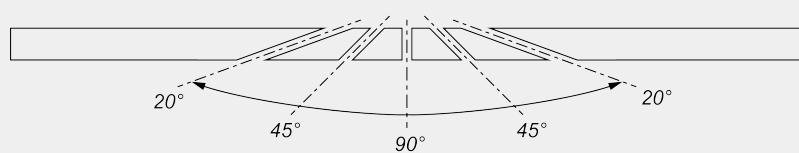
Réglage mécanique des angles intermédiaires
