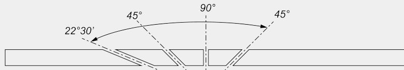
Réglage mécanique des angles intermédiaires
