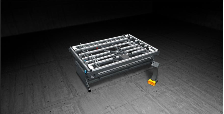
Banco dedicato all'assemblaggio della cornice di alluminio con la guarnizione ed il vetro. Mediante una crociera il vetro viene sollevato e, grazie ad un sistema di morse autoallineanti, le cornici vengono pressate a due a due. Terminata la pressatura dei primi due lati, viene fatta ruotare la crociera ed è possibile pressare gli altri due lati.
