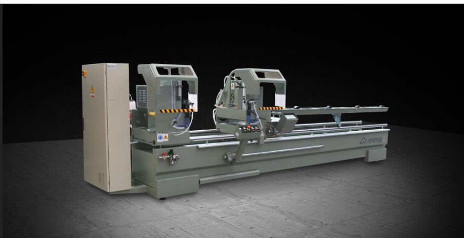
Troncatrice doppiatesta elettronica con movimento automatico della testa mobile tramite motore a C.C. e ribaltamento pneumatico delle teste all'esterno fino a 45° o 22°30' a seconda del modello. Lama da 450 o 500 mm. Dotata di computer industriale per una visualizzazione ottimale delle liste di taglio. Disponibile con taglio utile di 4,5,6 m di lunghezza.
