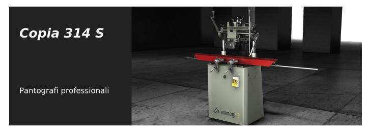
Pantografo monotesta a comando manuale con ampia corsa in altezza e movimento di traslazione testa con impugnatura o leva indiretta. Possibilità di eseguire lavorazioni passanti senza girare il pezzo. Tastatore a comando manuale.
