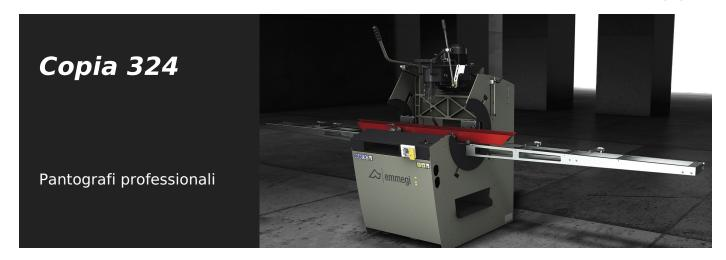
Pantografo monotesta a comando manuale con bloccaggio pneumatico e movimento di traslazione testa attraverso leva indiretta. Possibilità di eseguire lavorazioni passanti su alluminio senza girare il pezzo. Piano di lavoro antigraffio. Tastatore a comando manuale.
