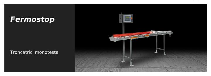
Sistema di riscontro della misura e supporto profilo con movimento del fermo su asse CN e lettura elettronica tramite banda magnetica assoluta. Corredato di sistema elettronico di misura che permette di salvare i dati su memoria interna oppure di trasferirli in tempo reale a un PC o all'unità di controllo di una troncatrice via Bluetooth. Permette lavorazioni con alta precisione e ripetibilità di posizionamento.
