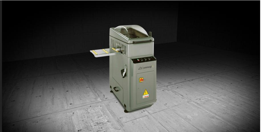
Intestatrice orizzontale ad avanzamento elettropneumatico. Fresatura fuori quadro +45° / 90° / -45°. Alta velocità di rotazione utensile per migliorare la qualità della lavorazione sul profilato verniciato e fuori quadro. Cambio rapido del gruppo frese con comando pneumatico. Piano di lavoro antigraffio. Zona lavoro integralmente carenata ad ampia visibilità interna.
