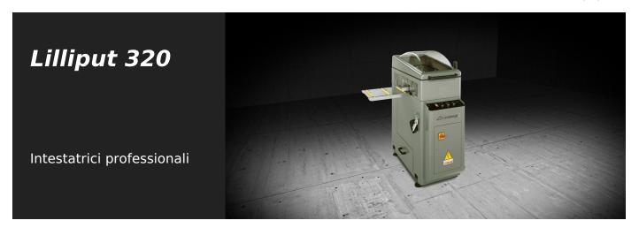
Intestatrice orizzontale ad avanzamento elettropneumatico. Fresatura fuori squadro +45° / 90° / -45°. Alta velocità di rotazione utensile per migliorare la qualità della lavorazione sul profilato verniciato e fuori squadro. Cambio rapido del gruppo frese con comando pneumatico. Piano di lavoro antigraffio. Zona lavoro integralmente carenata ad ampia visibilità interna.
