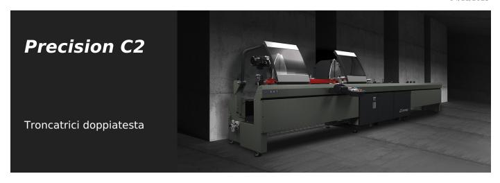
Troncatrice doppiatesta elettronica con movimento automatico della testa mobile tramite motore brushless comandato da un controllo numerico. Inclinazione pneumatica delle unità di taglio da 90° fino a 22°30′ (esterna) con sistema meccanico di regolazione delle angolazioni intermedie. Avanzamento lama oleo-pneumatico.
