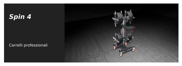
Carrello portaguarnizioni. Aspo frizionato e guidafilo assicurano lo sbobinamento senza inconvenienti della guarnizione. È dotato di sistema di cambio rapido delle bobine.
