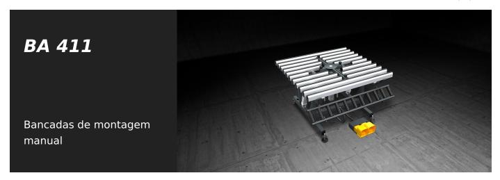
Bancada dedicada à ensamblagem do quadro de alumínio com a junta e o vidro. Mediante uma cruzeta o vidro é levantado e graças a um sistema de morsas com autoalinhamento os quadros são prensados dois a dois. Uma vez concluída a prensagem dos primeiros dois lados, faz-se girar a cruzeta e é possível prensar os outros dois lados.
