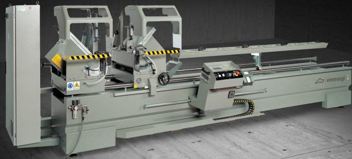
Máquina de corte com cabeça dupla eletrónica com movimento automático da cabeça móvel através de motor a corrente contínua (CC) e inversão pneumática das cabeças para o lado externo até 45° ou 22°30', de acordo com o modelo. Disco de corte de 450 e 500 mm. A máquina é dotada de medidor eletrónico de espessura do perfil. Disponível com corte útil de 4, 5 e 6 m de comprimento.
