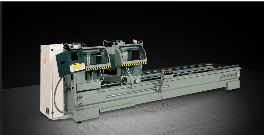
Máquina de corte com cabeça dupla eletrónica de 5 eixos para cortes compostos. Rotação motorizada e controlada eletronicamente pelo eixo horizontal ( $22^{\circ}30'$  externos e  $45^{\circ}$  internos) e pelo eixo vertical ( $45^{\circ}$  internos). Disco de corte de 500 mm. Disponível com corte útil de 4 e 6 m de comprimento.
